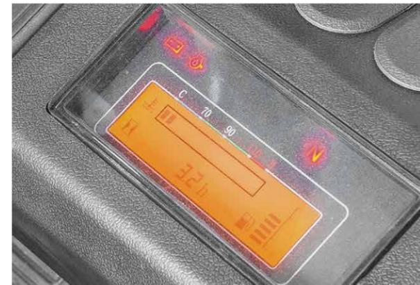
Новая LCD приборная панель имеет обширные функции и более стабильную работу, отображает рабочее состояние погрузчика, диагностику неисправностей, всю важную информацию, что позволяет оператору удобно получать информацию о состоянии погрузчика и своевременно проводить техническое обслуживание.
