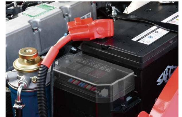
Применение интегрированного электрического короба нового поколения делает обслуживание и ремонт удобным, компоновка становится более разумной и с лучшими влагозащитными характеристиками.
